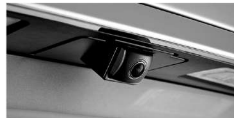
Conexión a cámara de retroceso
